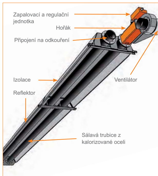
Plynové vytápění - tmavý infrazářič
